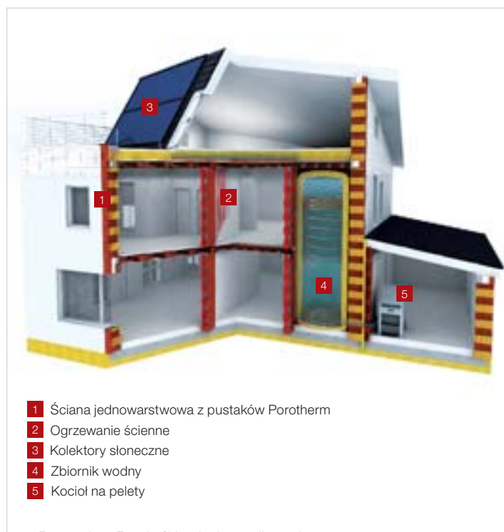
Rysunek 1. Przekrój budynku e4 ilustrujący zastosowane systemy
